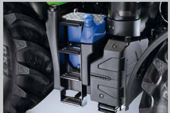
Mniejsze zużycie paliwa i AdBlue. 400-litrowy zbiornik paliwa i 50-litrowy zbiornik AdBlue umożliwiają dłuższą pracę bez tankowania.
