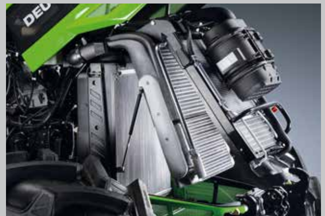
Nowa konstrukcja układu chłodzenia. Otwierany pakiet chłodnic ułatwia obsługę.
