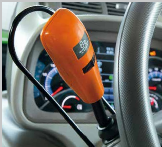
Rewers PowerShuttle z SenseShift, 5 poziomów czułości zmiany kierunku, regulowanych za pomocą pokrętła.
