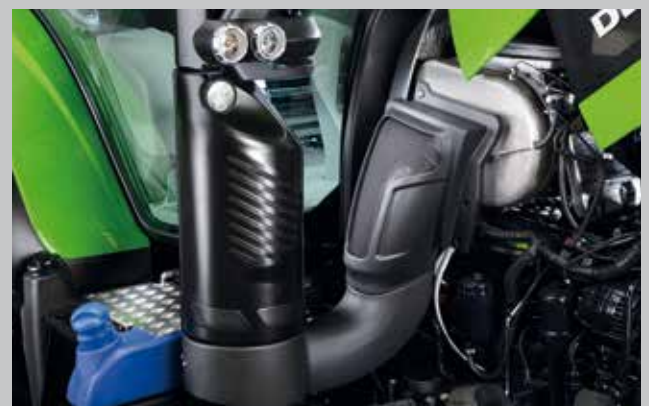
Układ oczyszczania spalin SCR DPF (filtr cząstek stałych) z pasywną regeneracją zapewnia oszczędność paliwa i zmniejszenie kosztów eksploatacji.
