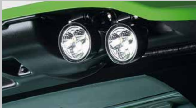
Wyjątkowy pakiet oświetlenia. Reflektory LED, 2500 lumenów na jedną lampę.
