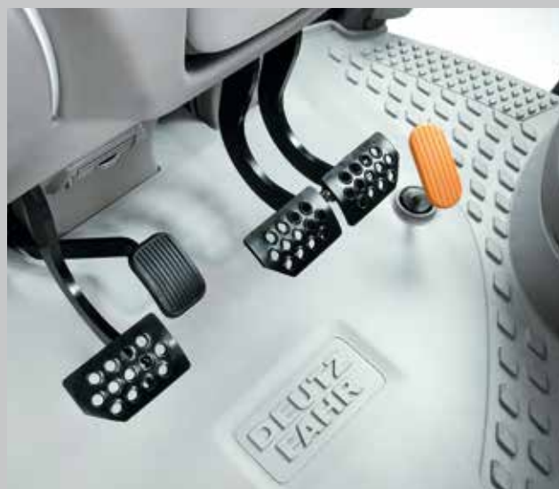
Wspomagany układ hamulcowy zapewnia wysoką skuteczność hamowania przy minimalnej sile nacisku na pedał.
