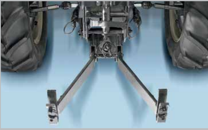
Podnośnik i WOM przedni. Zintegrowany podnośnik oferuje udźwig 600 kg, WOM przedni obraca się z prędkością 1000 obr./min.
