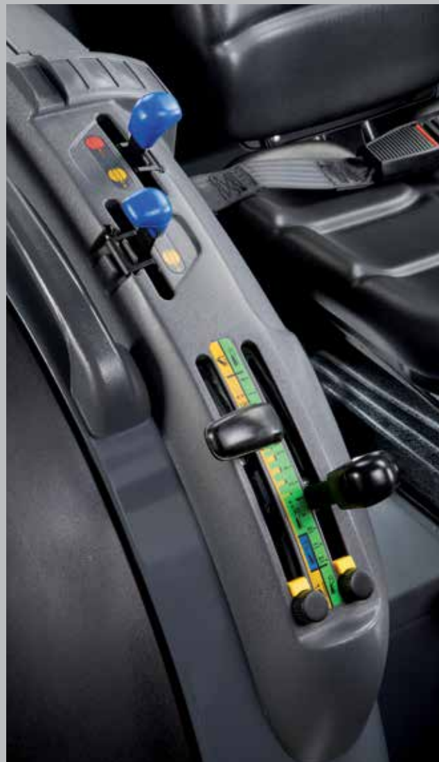
Podnośnik mechaniczny to proste sterowanie i pełna kontrola, Obok znajdują się dźwignie sterowania hydrauliką. Trzeci obwód aktywowany jest za pomocą przycisku.
