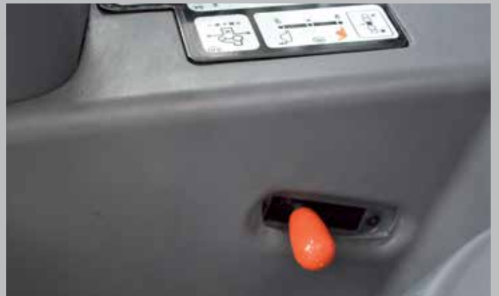
Reduktor: do prac z ultra-niskimi prędkościami jazdy.
