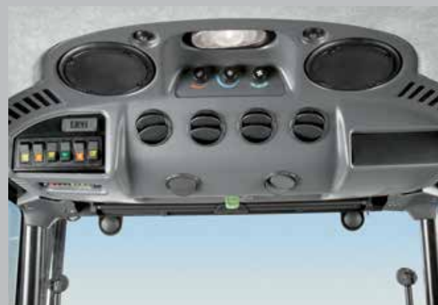
Układ klimatyzacji i ogrzewania zamontowany w dachu kabiny.
