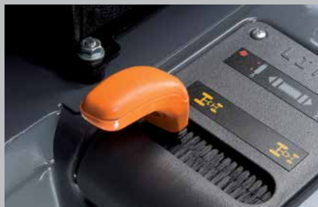
Napęd na 4 koła sterowany mechanicznie za pomocą dźwigni. Najlepsza trakcja w każdych warunkach.
