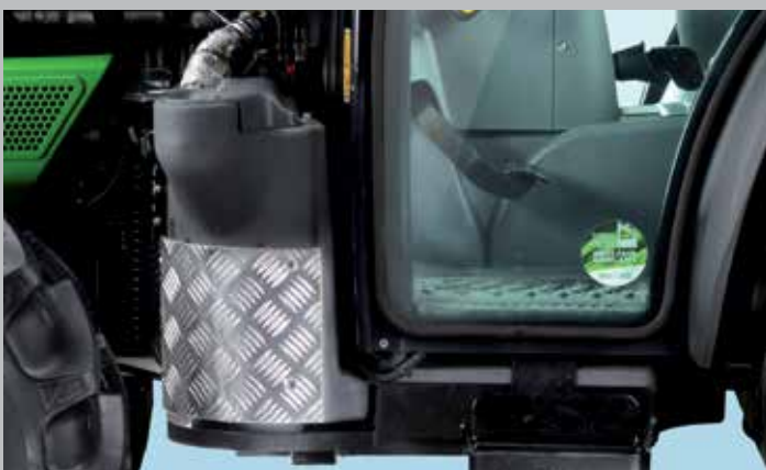
Dodatkowy zbiornik paliwa (15 litrów): dla wydłużenia czasu pracy bez tankowania.
