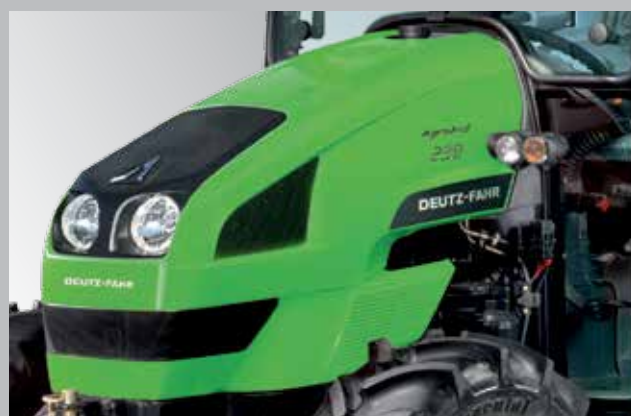
Wloty powietrza wykonano z materiału o nazwie Telene®.
