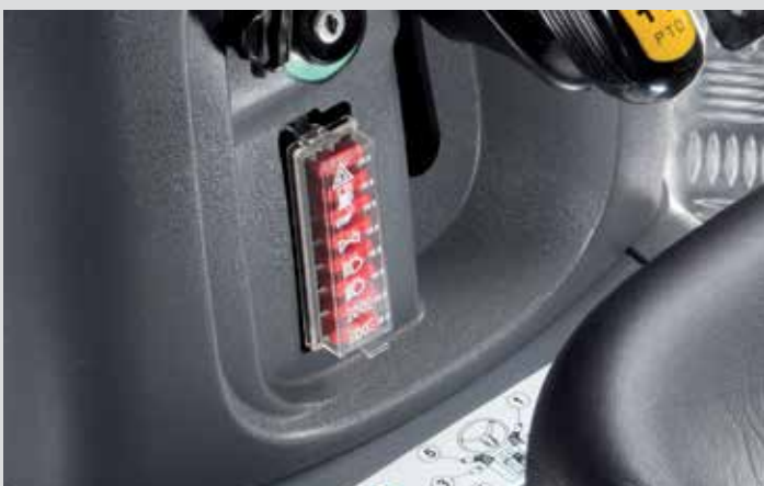
Bezpieczniki umieszczone bezpośrednio na kolumnie kierownicy, możliwość zmiany bezpiecznika bez konieczności demontażu osłon i paneli.
