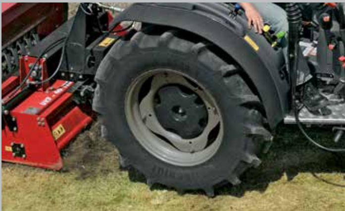
Ociążniki kół tylnych ciągnika. Doskonały rozkład masy, dobra trakcja.
