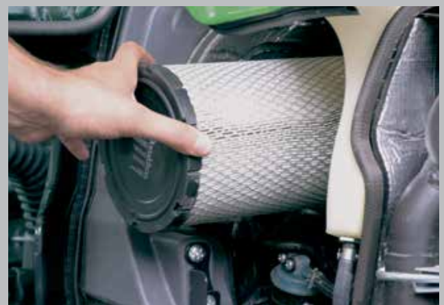
Filtr powietrza dostępny po uniesieniu maski silnika po jednej ze stron ciągnika.
