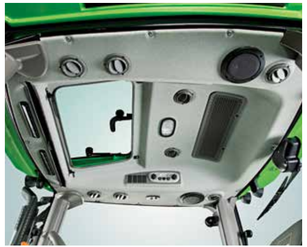
Szklany szyber-dach, szereg nawiewów, instalacja radiowa.
