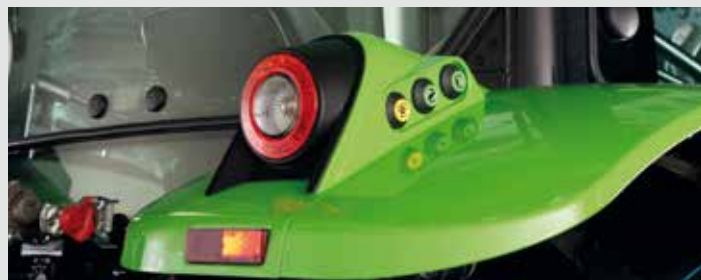
Przyciski sterowania WOM i podnośnika na błotnikach kabiny.
