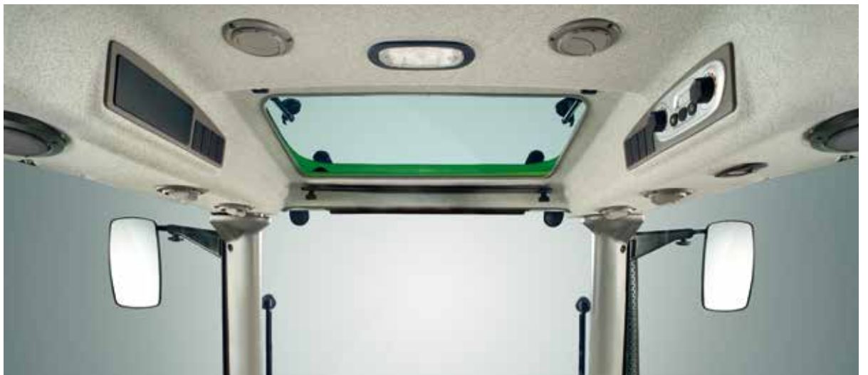
Doskonała widoczność na wysięgnik i osprzęt - duży szklany szyber-dach.
