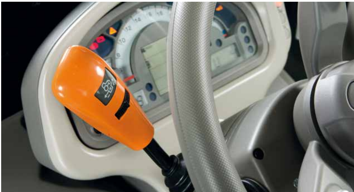
Dźwignia rewersu elektro-hydraulicznego Powershuttle z potencjometrem do regulacji szybkości reakcji ciągnika w trakcie zmiany kierunku jazdy. Rewers posiada regulację w pięciu ustawieniach od agresywnej, poprzez pośrednie do łagodnej.
