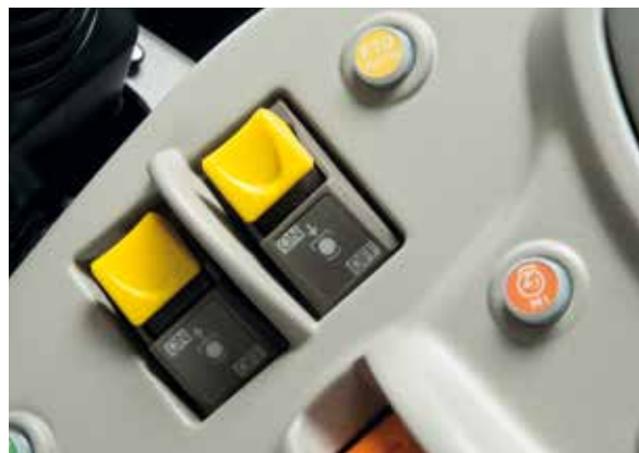
Przyciski sterowania przedniego i tylnego WOM.
