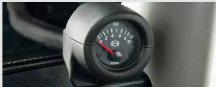
Wskaźnik ciśnienia pneumatycznego układu hamulcowego.
