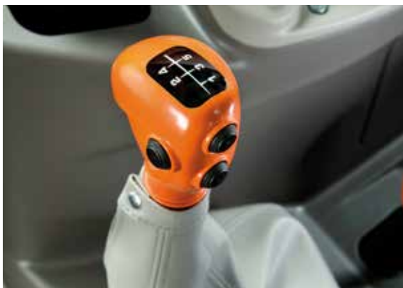
Dźwignia zmiany biegów z przyciskami zmiany półbiegów Powershift i przyciskiem sprzęgła ComfortClutch.
