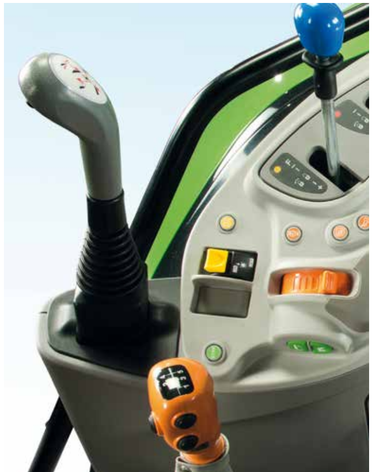
Zintegrowany joystick sterowania w prawej konsoli ciągnika.
