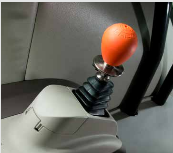
Hamulec postojowy ParkBrake z krótką dźwignią obok fotela.
