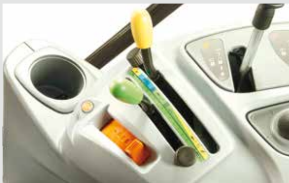
Dźwignie sterowania podnośnika mechanicznego MHR.
