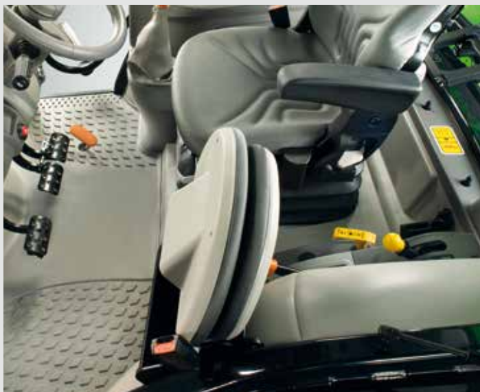
Nowe mocowanie, kształt i mechanizm automatycznego składania fotela pasażera modeli DEUTZ-FAHR Serii 5G.
