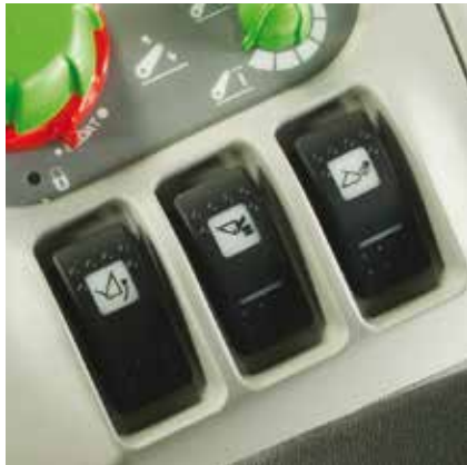
Dodatkowe przyciski sterowania wysięgnikiem.
