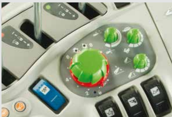
Panel sterowania podnośnika elektronicznego EHR.
