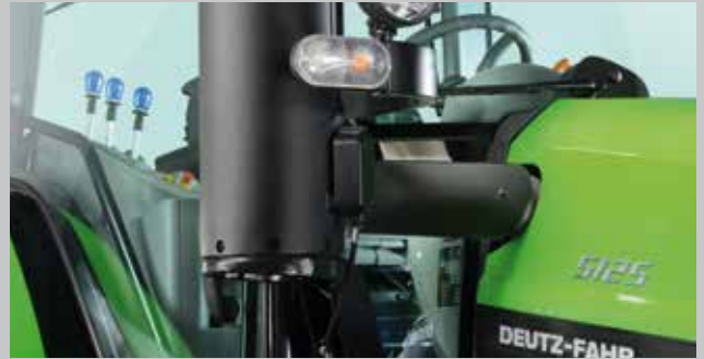
Układ oczyszczania spalin z selektywną redukcją katalityczną (SCR) ...
