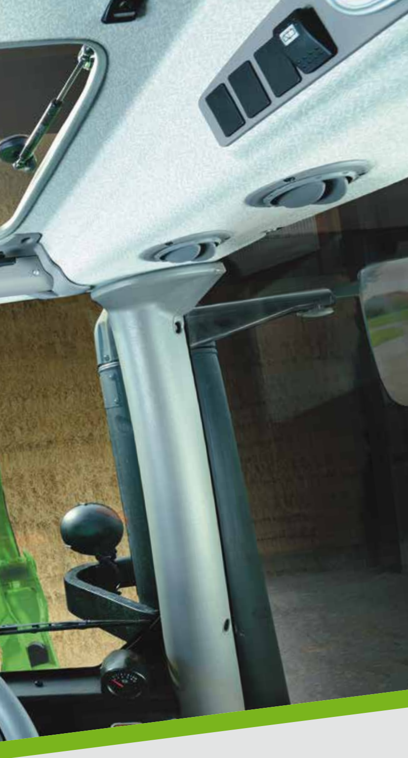
Nowy joystick ładowacza z przyciskami zmiany pól biegów Powershift. Przyciski uruchamiania systemów Stop&Go oraz SDD ...
