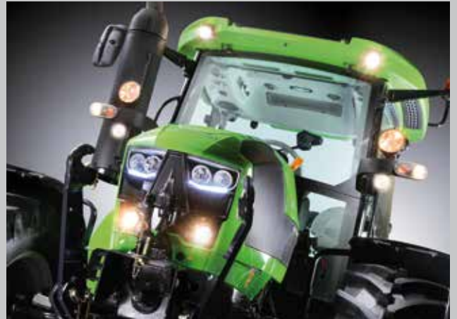
Pakiet oświetlenia. Optymalna widoczność w każdym kierunku nawet w trudnych warunkach atmosferycznych. Dodatkowe światła LED do jazdy dziennej w masce silnika.
