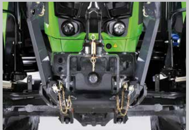
Fabryczny podnośnik przedni oferuje udźwig do 2100 kg, przedni WOM obraca się z prędkością 1000 obr./min.
