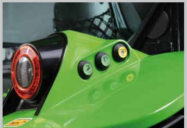
Przyciski sterowania WOM i podnośnikiem tylnym na błotnikach ciągnika.
