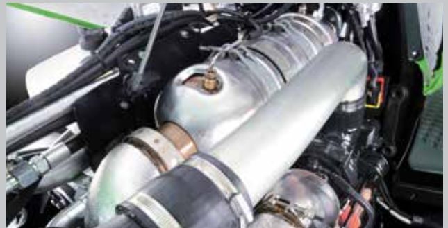
... oraz katalizatorem utleniającym Diesel Oxidation Catalyst (DOC) .
