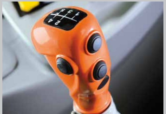
Nowe sterowanie dźwigni z linkami Bowdena. Łatwa zmiana biegów.
