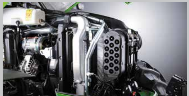
... podobnie jak pakiet chłodnic z wentylatorem ze sprzęgłem wiskotycznym.
