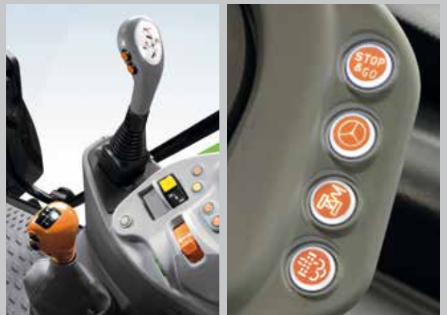
Nowy joystick ładowacza z przyciskami zmiany pól biegów Powershift. Przyciski uruchamiania systemów Stop&Go oraz SDD ...
