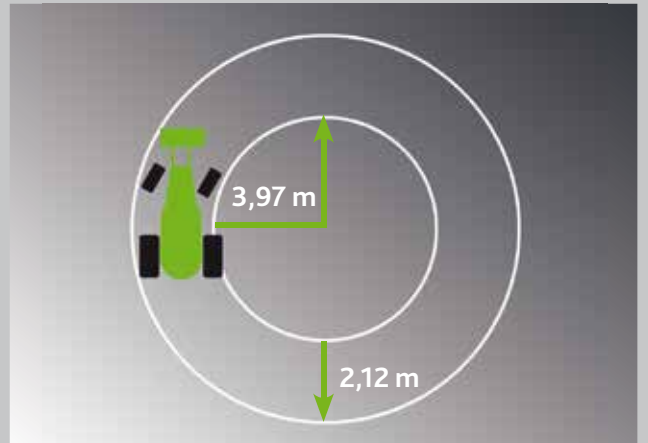
Promień zawracania, który wynosi tylko 3,97 metra pozwala na zwinne manewrowanie na małej przestrzeni (zależnie od ogumienia).
