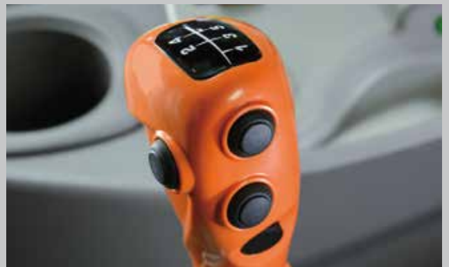
Przyciski sprzęgła ComfortClutch i zmiany półbiegów Powershift. Zmiana przełożeń bez użycia pedału sprzęgła w podłodze.
