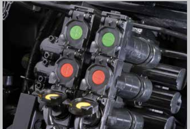
Nowe rozdzielacze hydrauliczne ze zwiększonym przepływem i regulatorem na wszystkie obwody.
