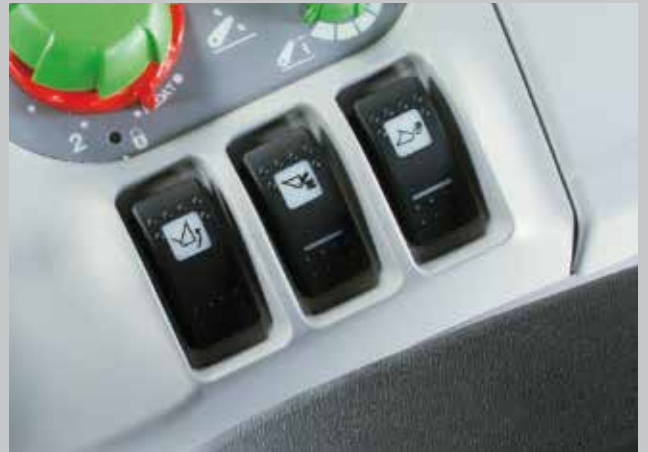
... i przyciski wszystkich funkcji ładowacza czołowego na prawej konsoli.
