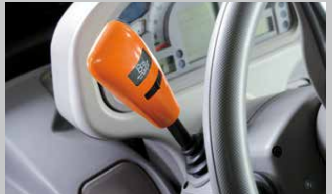
Rewers Powershuttle w standardzie. Dodatkowo - regulacja szybkości rewersu w pięciu ustawieniach.
