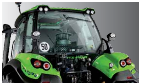
Wydatne oświetlenie w tylnej części kabiny.
