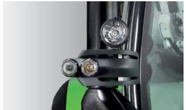
Światła zamontowane na słupkach kabiny ciągnika.
