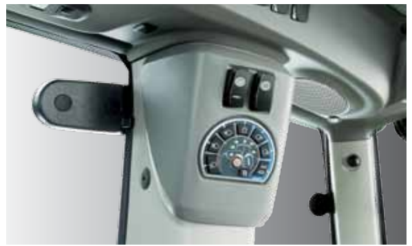
Panel sterowania oświetleniem na słupku kabiny.
