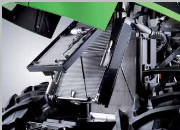
System otwierania pakietu chłodnic z siłownikami.
