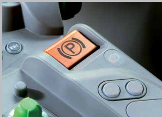
EPB - elektroniczny hamulec postojowy. Automatyčna blokada i rozłączenie hamulca, przycisk na podłokietniku.
