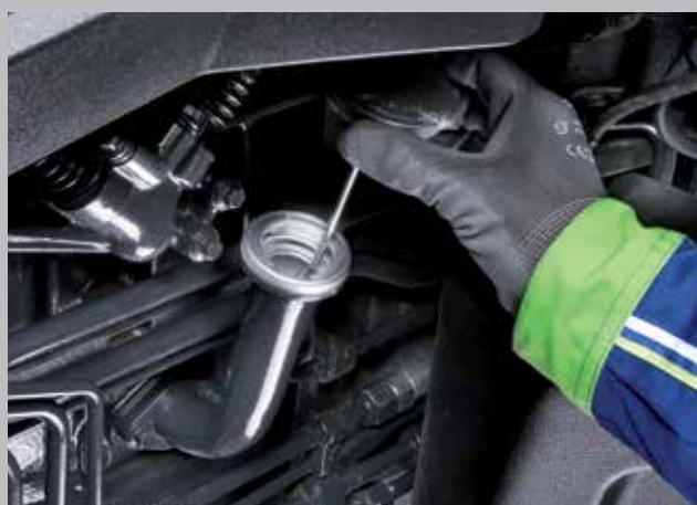
Kontrola oleju silnikowego nie wymaga użycia dodatkowych narzędzi.
