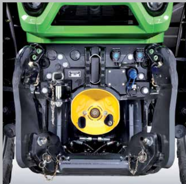
Nowy podnośnik przedni ze składanymi ramionami. Zwarta konstrukcja, łatwe sterowanie za pomocą przycisków.
