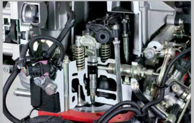
Układ wtryskowy DCR z maksymalnym ciśnieniem wtrysku 2000 bar.
