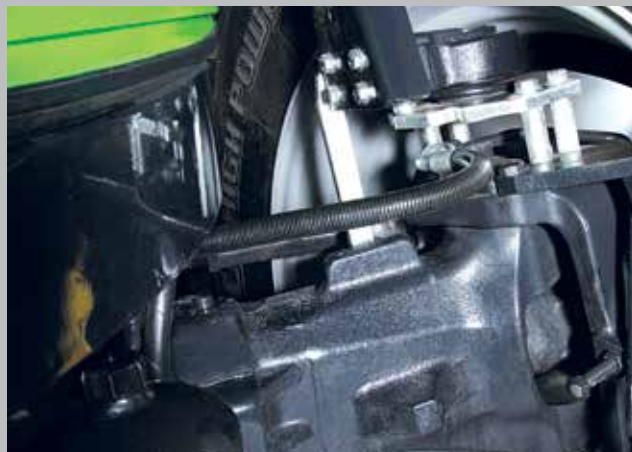
Oś przednia. Duży skok amortyzacji i kąt skrętu kół wynoszący maksymalnie 50 stopni.
