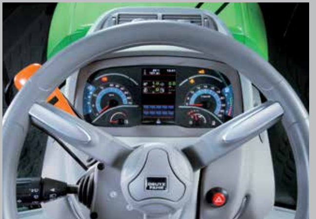
Nowy panel InfoCentre łączy przejrzyste zegary analogowe z dużym, czytelnym wyświetlaczem elektronicznym.
