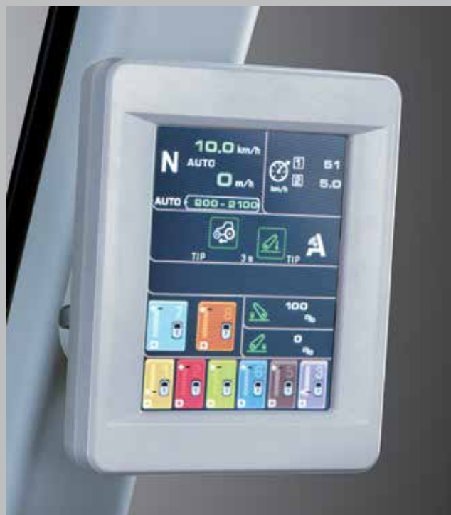
Trzy tryby pracy układu napędowego: manualny, automatyczny i WOM. Monitor WorkDisplay umieszczony na słupku kabiny.
