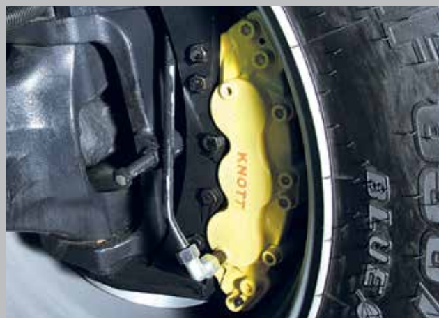
Suche, zewnętrzne tarcze hamulcowe przy napędzie umożliwiającą jazdę z prędkością maksymalną 50 km/h (opcja).
