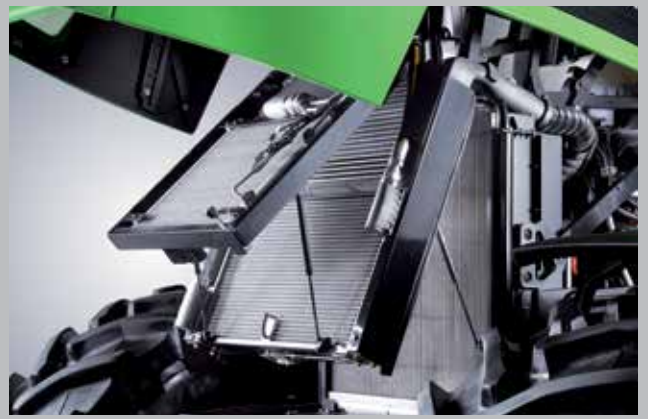
Kompaktowy pakiet chłodnic z systemem otwierania na silownikach.
