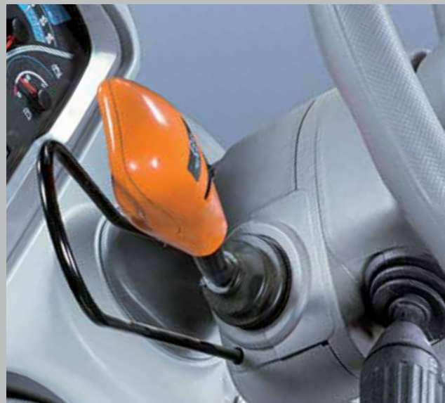
Rewers elektro-hydrauliczny Powershuttle w standardzie. Regulacja czułości rewersu za pomocą pokrętła na dźwigni rewersu.
