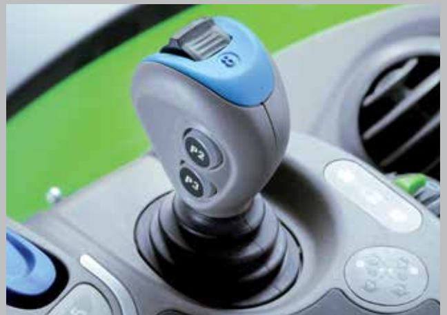
Trzy obwody hydrauliki sterowane za pomocą joysticka krzyżowego z dodatkowym przełącznikiem i przyciskami programowalnymi.
