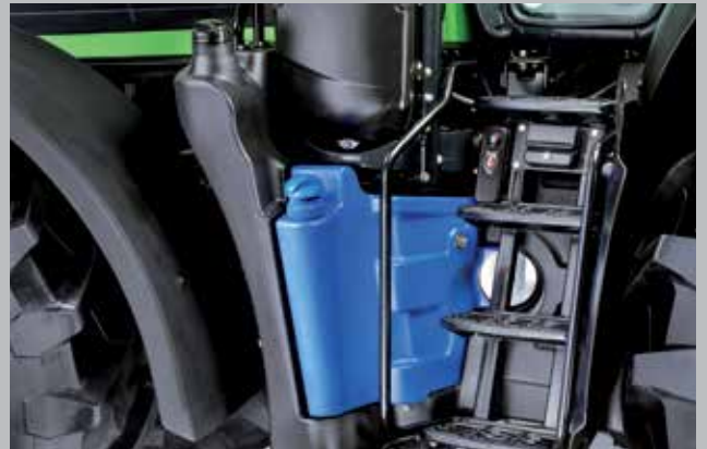
Zbiornik paliwa o pojemności 600 litrów i AdBlue 55 litrów. Modele Serii 9 TTV mogą być wyposażone w podgrzewacz pre-filtra paliwa.
