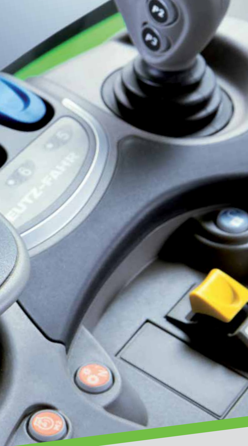
Trzy obwody hydrauliki sterowane za pomocą joysticka krzyżowego z dodatkowym przełącznikiem i przyciskami programowalnymi.
