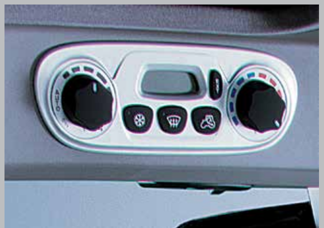
Panel sterowania układem automatycznej klimatyzacji.
