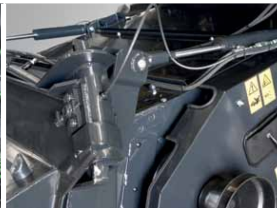
System elektrohydraulicznej regulacji kąta natarcia hedera zapewnia optymalną pozycję listwy tnącej względem terenu.
