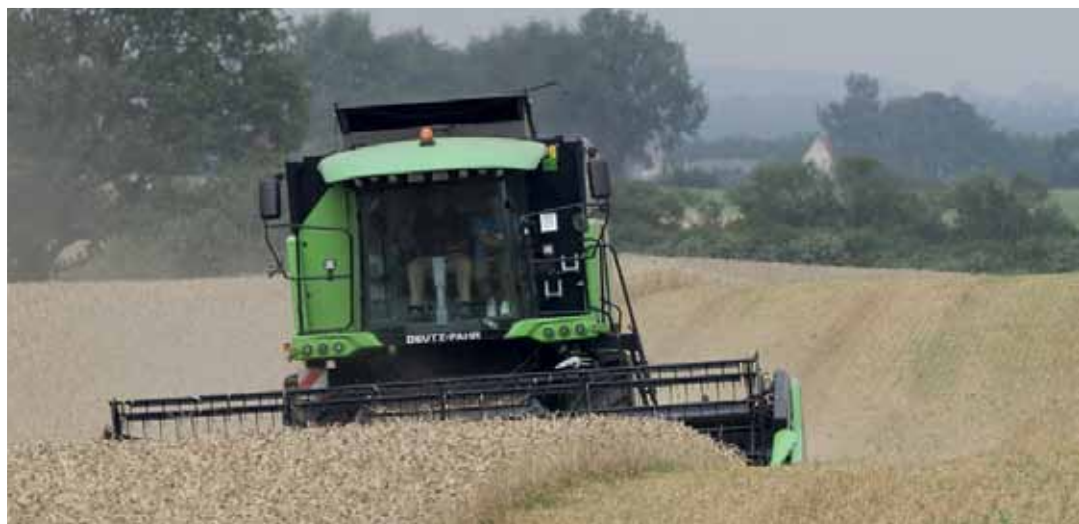
System AUTOCONTROL precyzyjnie steruje poprzecznymi i wzdłużnymi ruchami hedera dla utrzymania na stałym poziomie wysokości cięcia oraz zapewnienia optymalnego zbioru wyległego łanu, przy zachowaniu możliwie najwyższej jakości cięcia.
