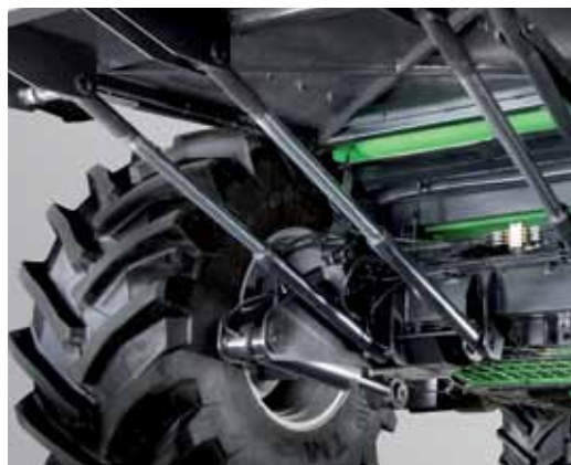
Przedni most o nacisku dopuszczalnym 25 ton, pozwala na pracę w najtrudniejszych warunkach z maksymalną niezawodnością oraz bezpieczeństwem pracy operatora.
