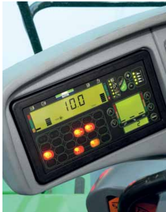
Nowoczesny system monitorowania parametrów pracy kombajnu (Combine Control Management) kontroluje w czasie rzeczywistym wydajność pracy.
