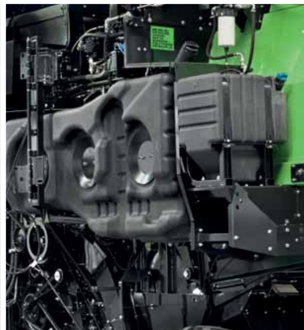
Zbiorniki paliwa i płynu AdBlue® wykonane są z polietylenu o grubości 10 mm.
