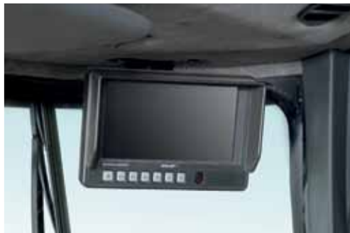
4 obrazy z kamer na 7" monitorze. kamery pracują także w podczerwieni.
