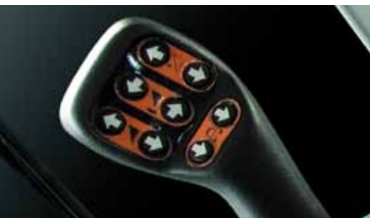
Dzięki joystickowi Commander Stick operator kontroluje wszystkie funkcje kombajnu i może z dużą swobodą i komfortem skupić się na wykonywanej pracy.
