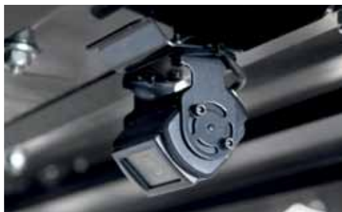
Tylna kamera skierowana na zaczep ułatwia sprzęganie wózka do transportu hedera.
