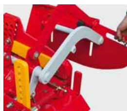
Kroje boczne prowadzone w równoległoboku
