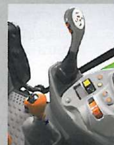
Dźwignia sterująca ładowaczem czołowym montowana fabrycznie.
