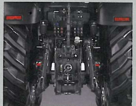
Podnośnik tylny EHR o udźwigu 12000 kg, hydraulika z pompą Load-Sensing 210 l/min, trzy prędkości tylnego wałka odbioru mocy.
